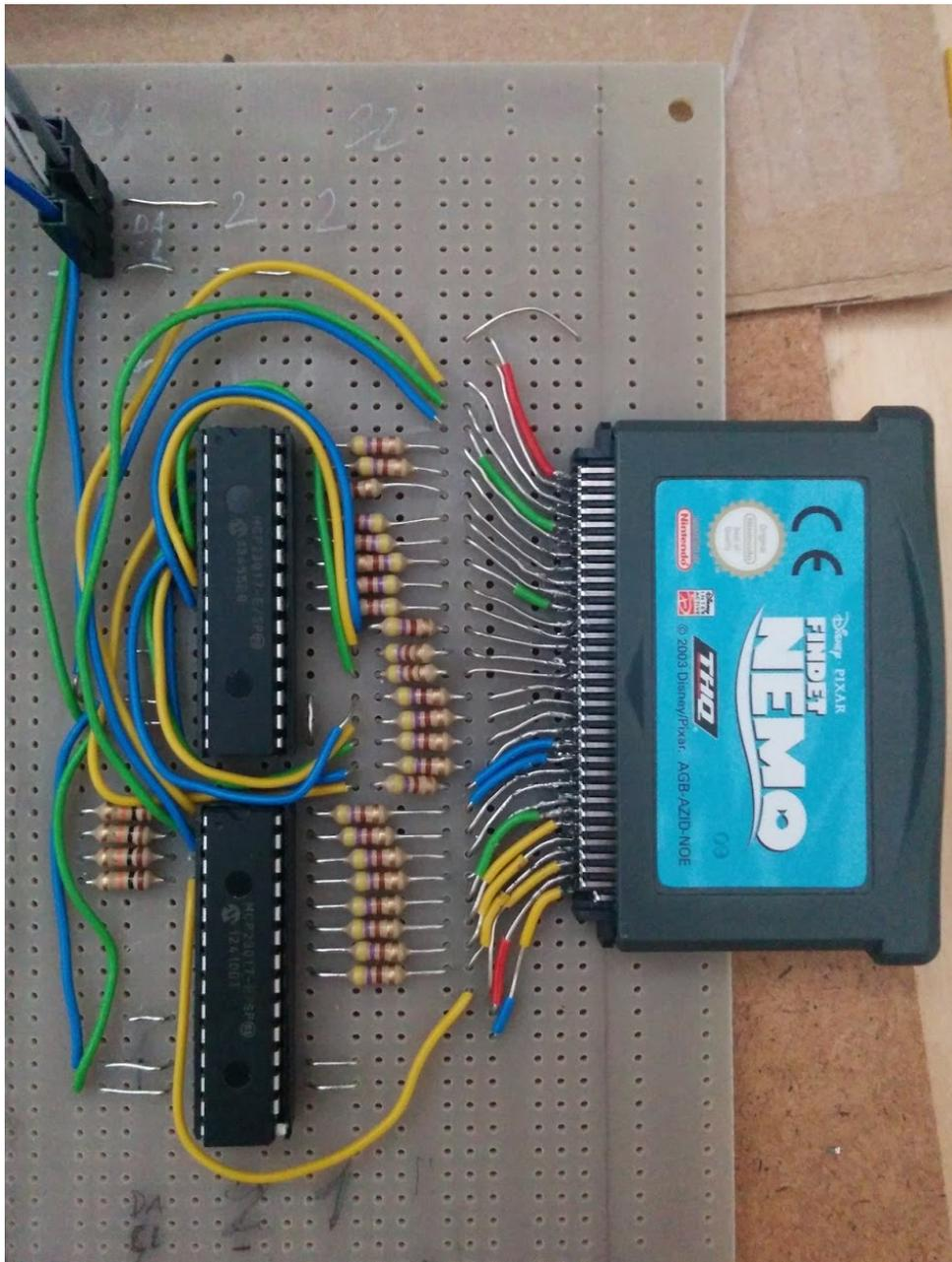
Maximale Lesegeschwindigkeit ca. 1 MB/min. Maximale Modulgröße 32 MB.
